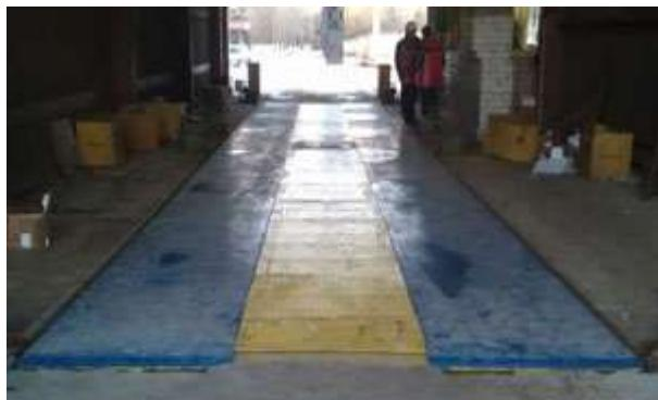
Весы автомобильные состоят из грузоприемной платформы (имеющей одну или несколько секций), комплекта узлов весовых на основе тензорезисторных (электронных) датчиков и весоизмерительного устройства. Количество секций платформы определяется грузоподъемностью и условиями эксплуатации.
