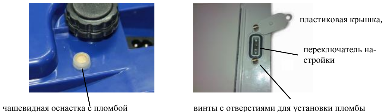
Рисунок 2 — Схема пломбировки весов от несанкционированного доступа
